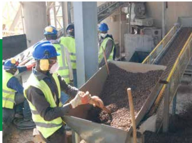
A la suite d'une expérimentation concluante de substitution progressive du charbon organique par les combustibles alternatifs biologiques dans le processus de production du Clinker à SCANTOGO, nous procédons désormais à la mise en place d'un système automatisé de chargement des combustibles alternatifs dans le four de SCANTOGO.
